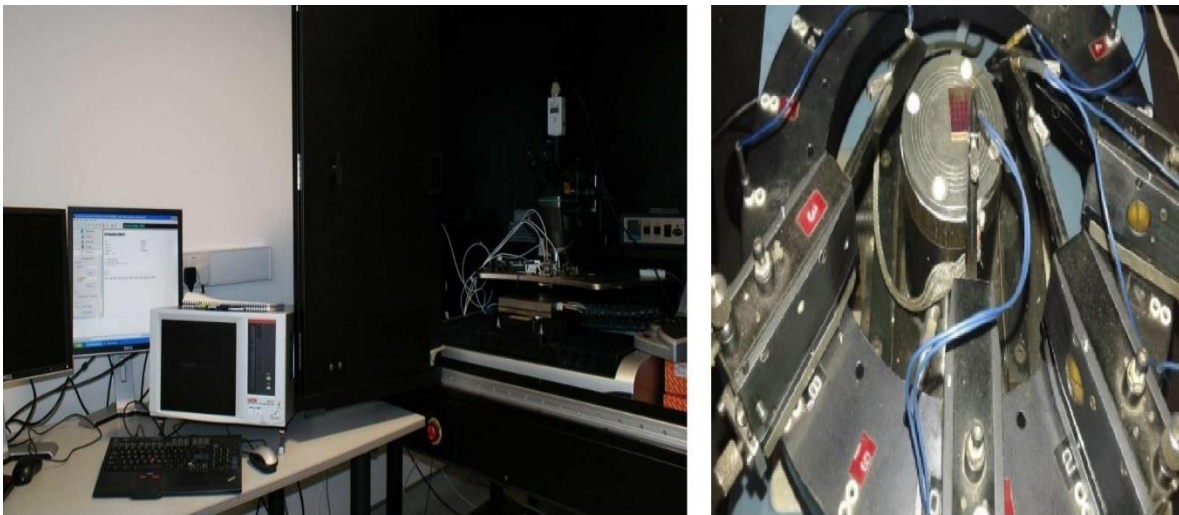
Figura 17. Sistema de caracterización de semiconductores para obtener curvas I-V.
