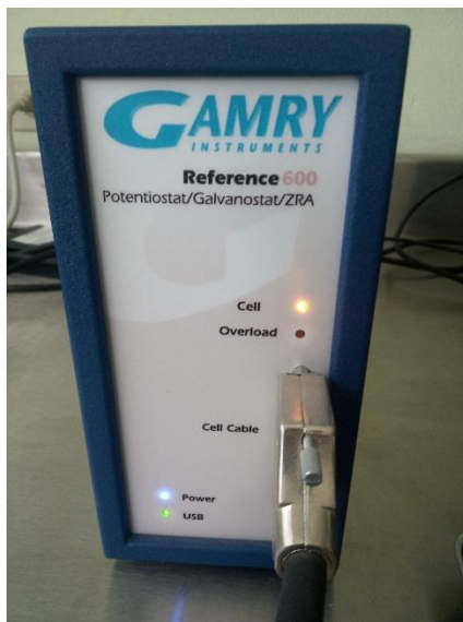
Figura 2.10 Potenciostato marca GAMRY, modelo Reference 600.
