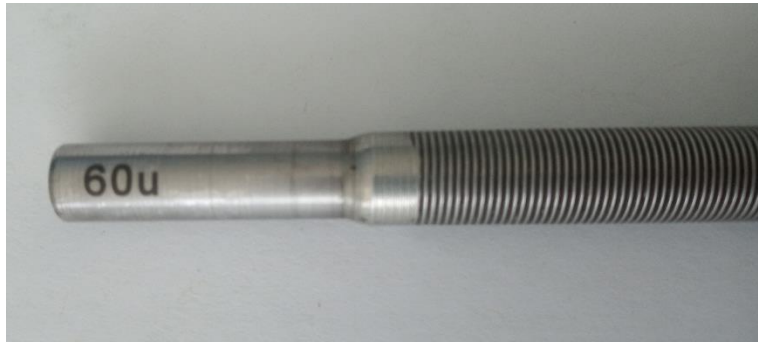
Figura 2.3 Barra aplicadora de 60 micras.
