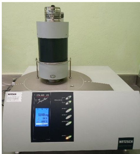
Figura 2.8. Analizador térmico Netzsch STA 449 F3 Jupiter.
