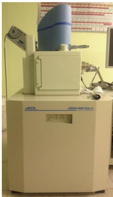
Figura 2.9 Microscopio electrónico de barrido marca JEOL modelo JSM-6610LV.
