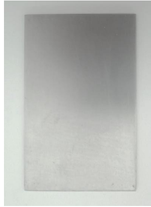
Figura 3.1 Sustrato de lámina de acero al carbón utilizado para la aplicación del recubrimiento.
