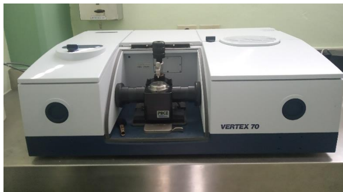
Figura 2.6 Espectrofotómetro marca Bruker modelo Vertex 70.
