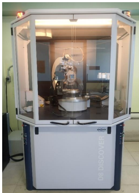
Figura 2.7 Difractómetro marca Bruker modelo D8.
