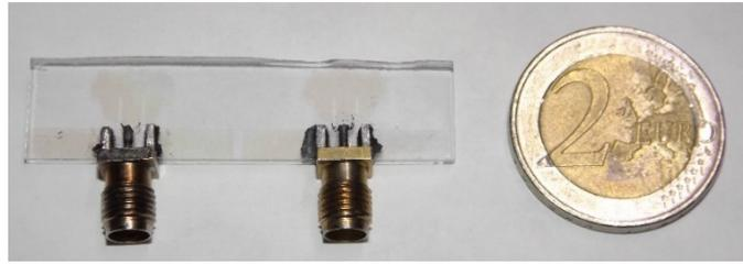
*Figura 3.21 Antena transparente fabricada, de dos puertos.*
