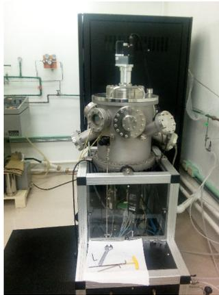
*Figura 2.7 Equipo para el depósito de películas por medio de sputtering.*
