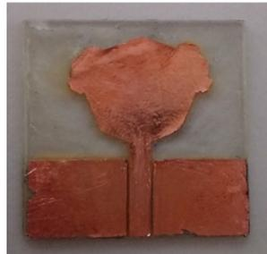
*Figura 3.19 Antena de cobre fabricada.*
