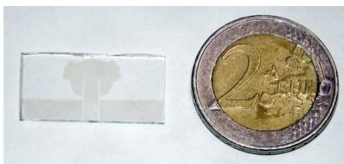
*Figura 3.18 Antena transparente fabricada*
