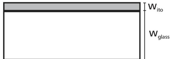
Figura 3.6 Corte transversal del material empleado para la antena con ITO.
