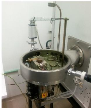
*Figura 2.8 Equipo para el depósito de películas por medio de beam epitaxy.*
