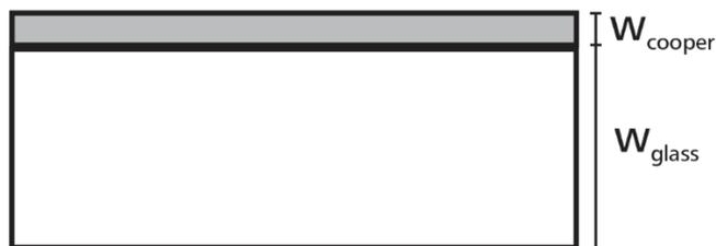
Figura 3.1 Corte transversal de la placa base con película de cobre.
