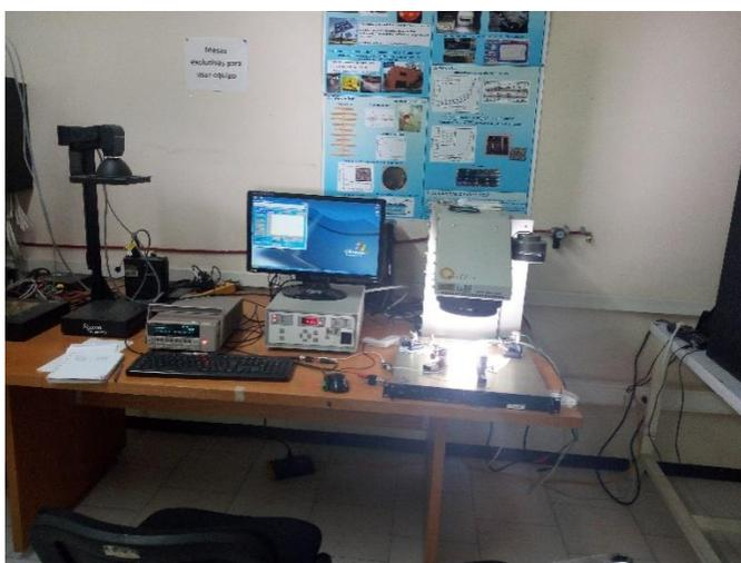
Figura 3.5: a) Simulador solar ORIEL SOL 2 con condiciones estándar AM 1.5.
