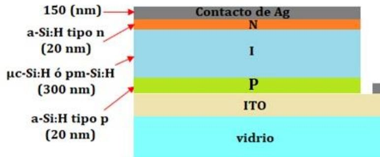
Figura 4.17 Diseño de celda PIN.
