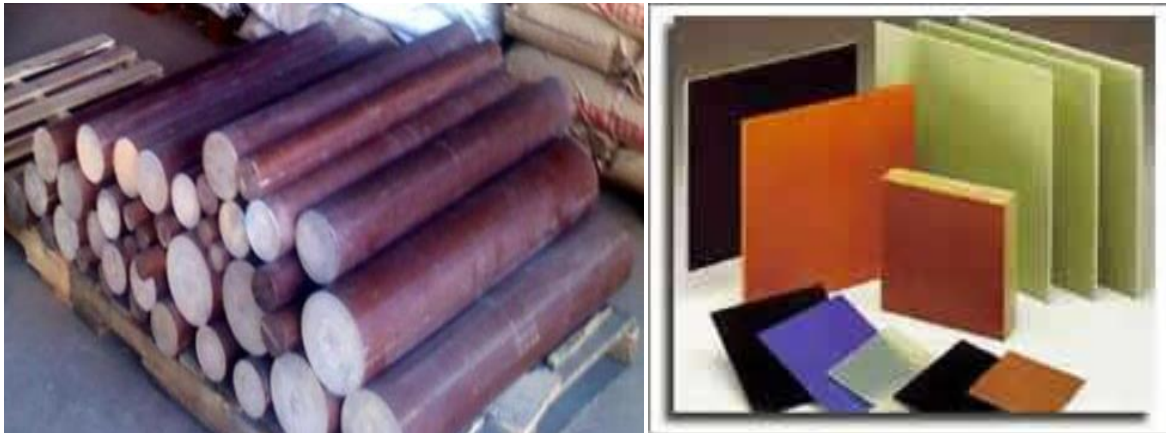
Figura 1: Material aislante celorón en sus dos presentaciones, en forma cilíndrica y en forma plana.
