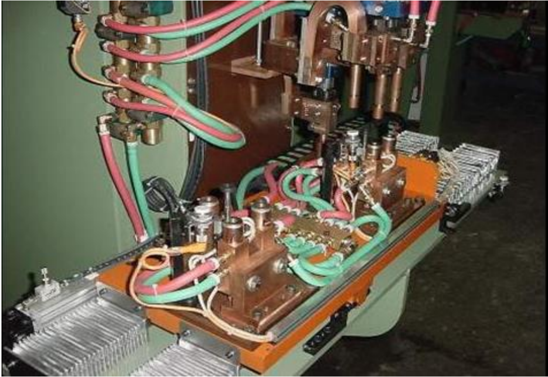
Figura 4.16: Circuito de refrigeración de maquinas de pedestal y de sobre mesa.
