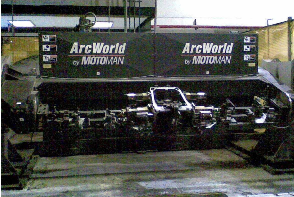
Figura 4.14: Sistema neumático utilizado en herramientas de soldeo de celdas dobles robotizadas para sujetar las piezas metálicas a soldar de un respaldo delantero lado izquierdo del modelo Bora A5.
