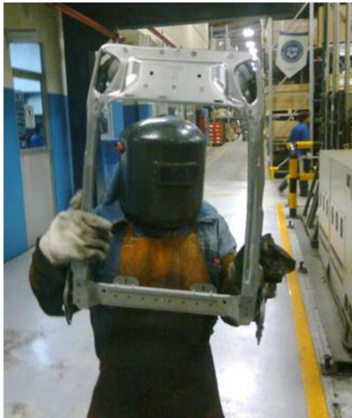
Figura 4.19: Respaldo delantero del Bora A5 de Volkswagen recién terminado de soldar fabricado en la empresa automotriz Johnson Controls Planta Tlaxcala.
