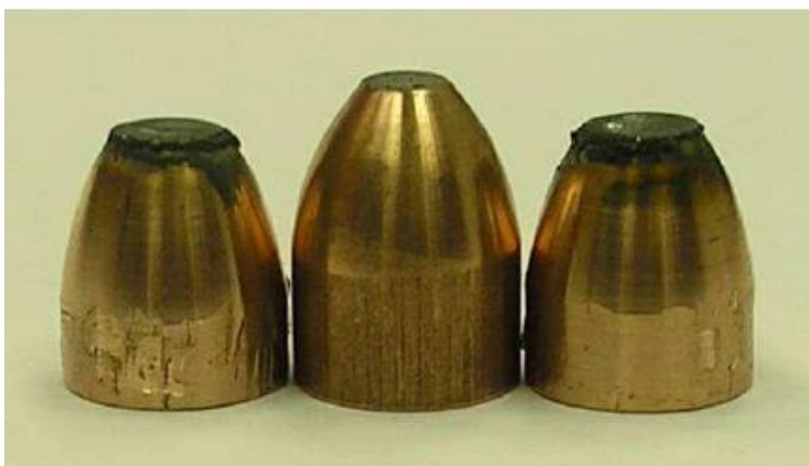
Figura 2.16: Electrodo con vida útil cumplida.
