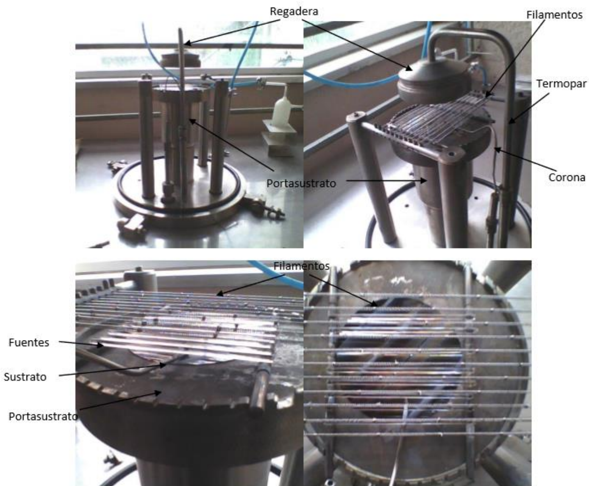
FIGURA ANEXO Componentes del sistema HFCVD
