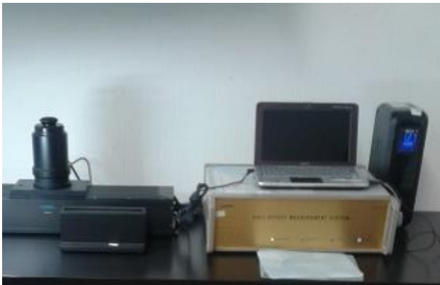
FIGURA 1.11 Sistema medidor de efecto Hall
