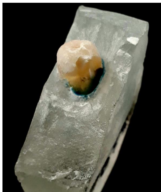
Fig 15, 16. Fotografías que demuestran la fractura coronal de las muestras en los grupos experimentales.
