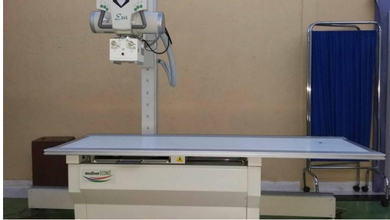
Figura 4.6: Equipo de rayos X COMED MEDICAL EVA HF-525 manejado en el laboratorio médico LINFOLAB, con el cual se realizaron las mediciones. Tiene un rango de 40-125 kV y 0.2-600 mAs.
