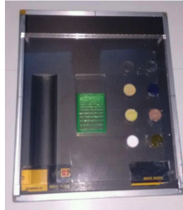
Figura 4.4: Imagen de la rejilla y los diferentes tipos de materiales de prueba utilizados en el fantoma.
