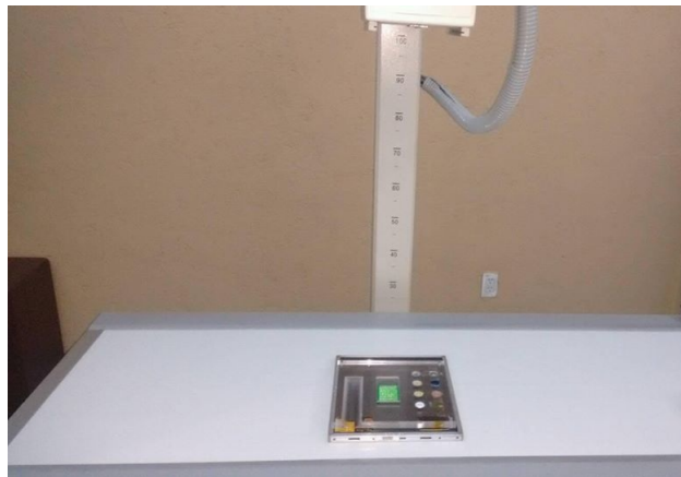
Figura 4.7: Diseño experimental para la toma de imágenes del fantoma.
