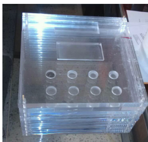
Figura 4.3: Imagen con todas las placas del fantoma construido para el equipo de rayos X.
