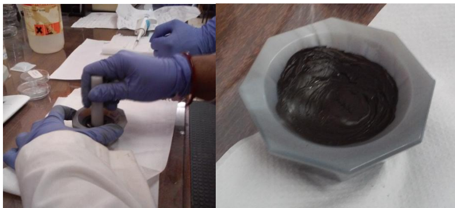
Fig. 3.5 Preparación de la pasta de \text{CuSbS}_2 .
