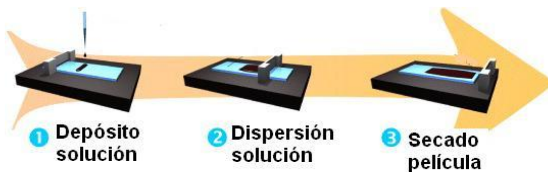
Fig. 3.4 Diagrama esquemático de la técnica “Doctor Blading” [39].
