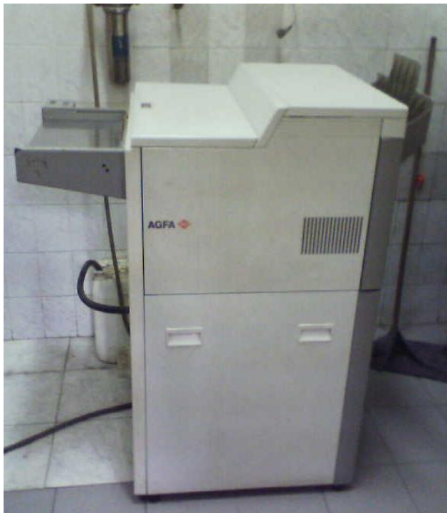
Figura 28-31. Reveladora automática, sistema de rodillos. http://tecnicosrx11.blogspot.com/2011/05/sala-de-rayos-x.html
