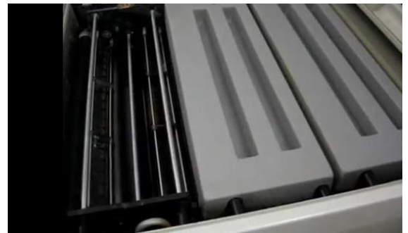
Figura 28-31. Reveladora automática, sistema de rodillos. http://tecnicosrx11.blogspot.com/2011/05/sala-de-rayos-x.html
