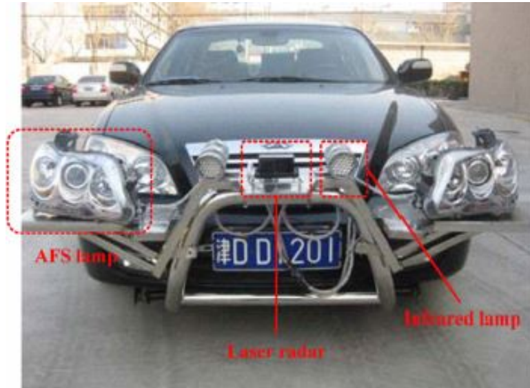
Figura 2.43: Implementación de sistema AFS en planta física.
