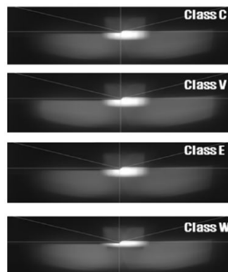
Figura 2.64: Resultados en la generación de los patrones de iluminación mediante el arreglo óptico.
