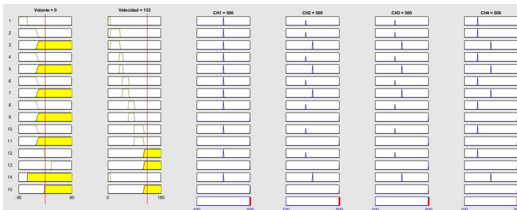
Figura 4.16: Resultado de inferencia para los 4 canales de iluminación en faro izquierdo bajo conducción sin giro en el volante a 133 km/h.
