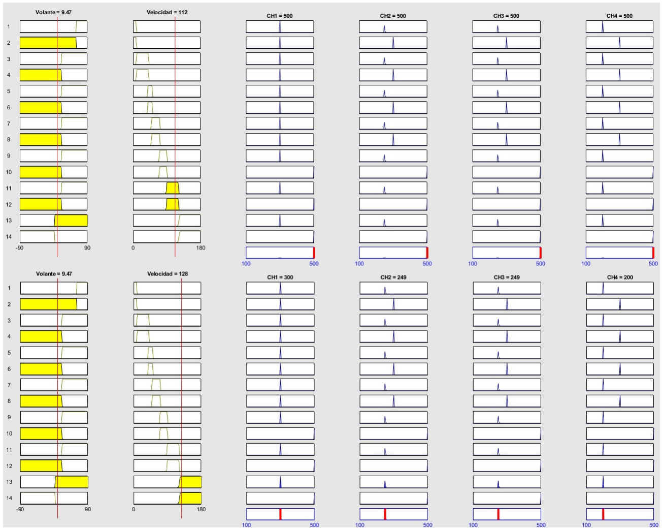
Figura 4.12: Imagen comparativa de los resultados de inferencia en un mismo ángulo de volante a la derecha reducido, a 112 Km/h y a 128 Km/h.
