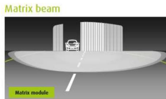
Figura 2.87: Patrón de Haz antideslumbramiento matrix beam.
