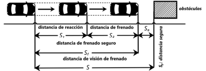
Fig. 6. Distancia visual de frenado (Stopping Sight Distance).
