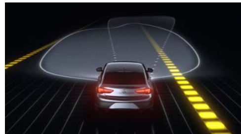
Fig. 13. Control automático del haz de Luz por AFS.
