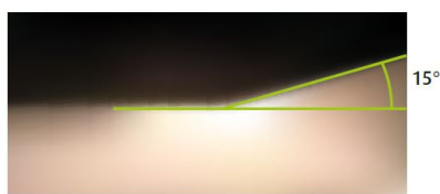
Figura 2.29: Ejemplificación de línea de corte para luz baja.
