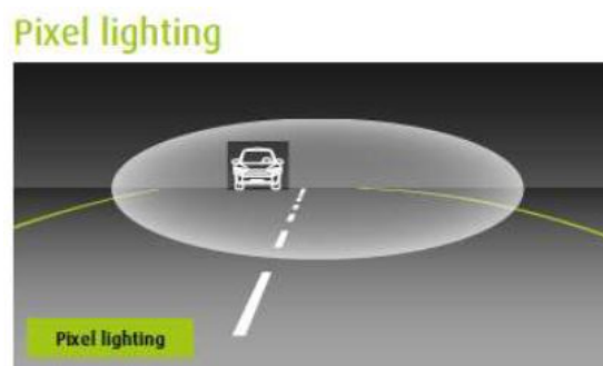
Figura 2.88: Patrón de Haz antideslumbramiento Pixel light.
