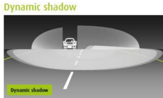
Figura 2.86: Patrón de Haz antideslumbramiento sombra dinámica.
