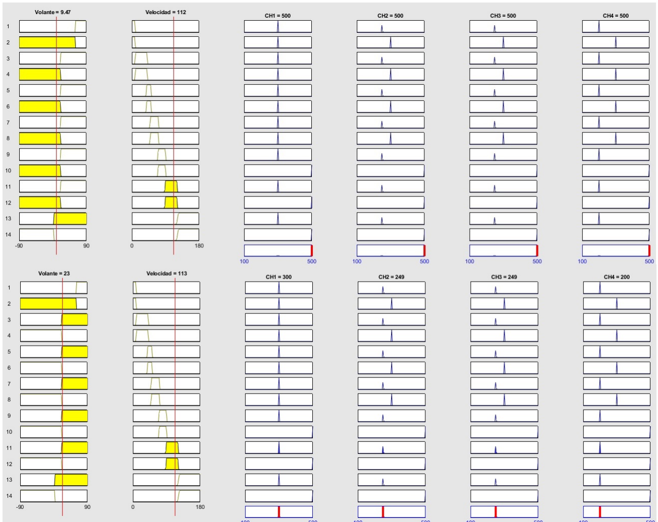
Figura 4.10: Resultado de inferencia para los 4 canales de iluminación en faro derecho bajo conducción con vuelta a la derecha a 112 km/h de velocidad, con ángulo de volante reducido 9.47 grados (superior) y con ángulo de volante pronunciado 23 grados(inferior).
