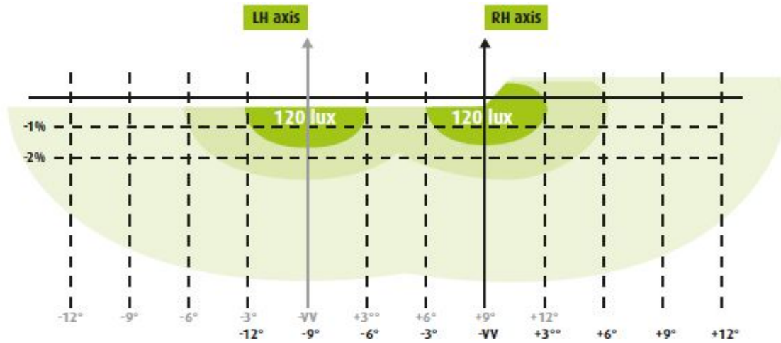
Figura 2.79: Carta fotométrica guía para haz clase E.
