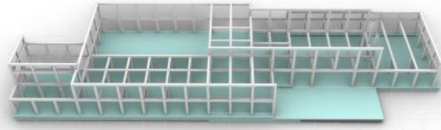
01_Losa de cimentación
