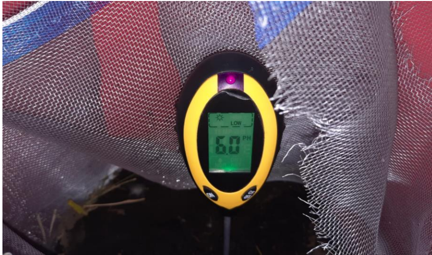
Figura 19. Equipo digital de medición de pH, temperatura y humedad. Fuente: Autoría propia.
