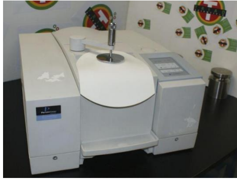
Figura 2.5. Equipo de espectroscopia PERKINS Perkin Elmer SPECTRUM ONE FTIR (tomado de https://es.bimedis.com/a-item/equipo-de-espectroscopia-perkins-perkin-elmer-spectrum-one-ftir-1476541 )
