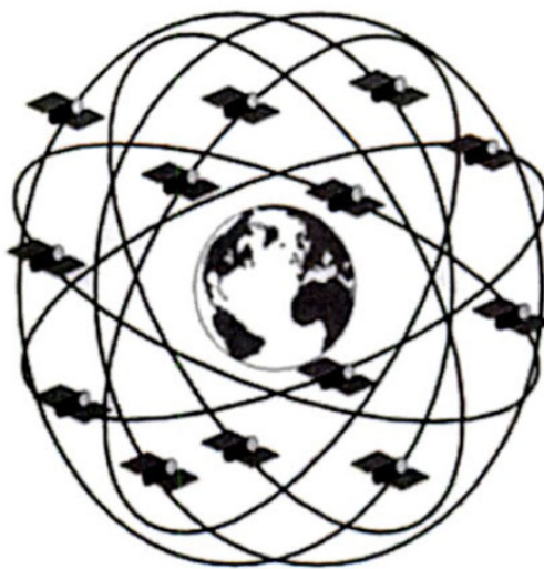
Figura 4.2: La tecnología GPS se basa en un grupo de 24 satélites que emiten señales a la Tierra.
