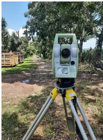
Fig. 50 Estación total marca Hi-Tarjet utilizada en el proyecto.
