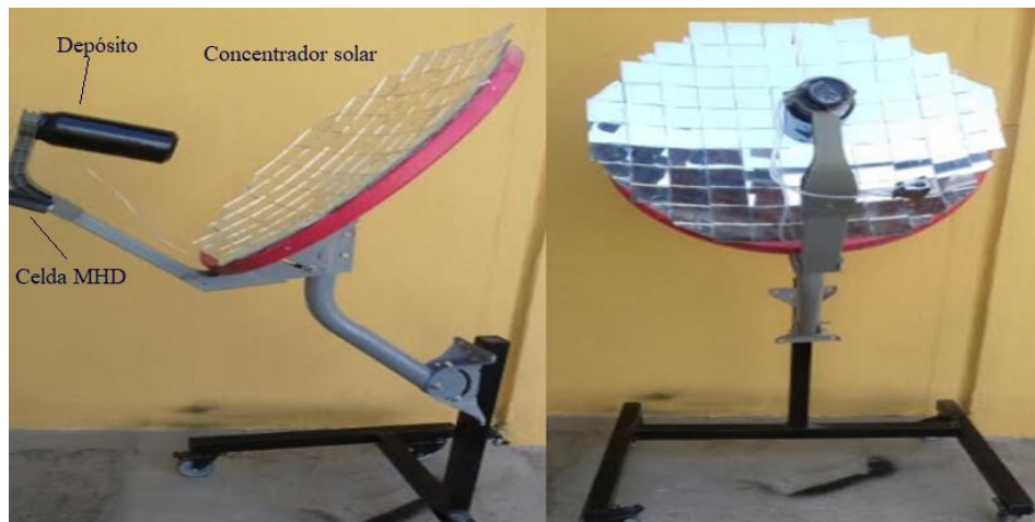
Figura 16. Generador MHD solar operado con radiación solar concentrada
