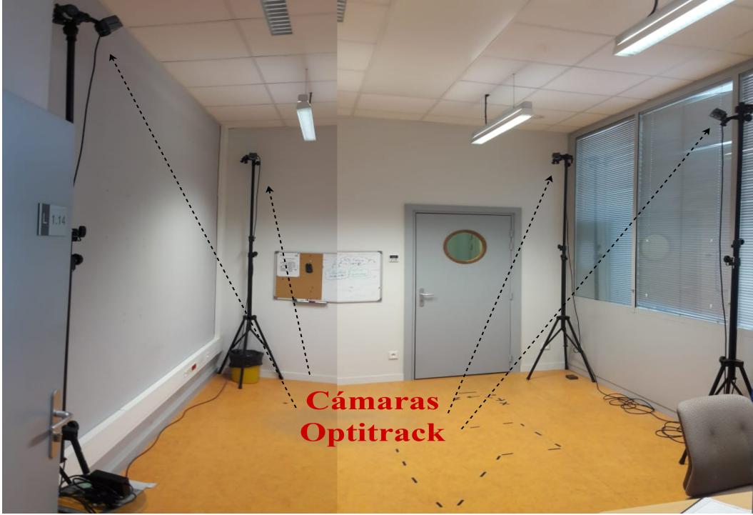
Figura 4.13: Sala de captura de movimiento con cuatro cámaras Optitrack
