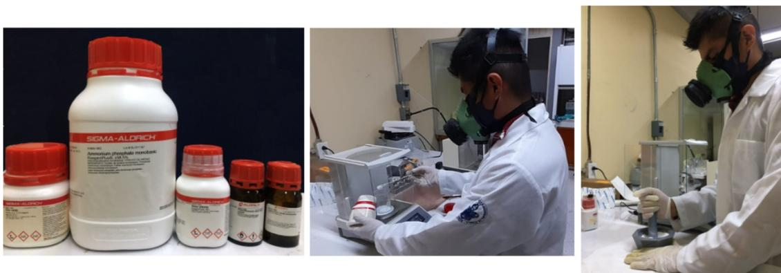
Figura 3.1: (a) Reactivos precursores, (b) pesado de muestras, (c) molido de los polvos.
