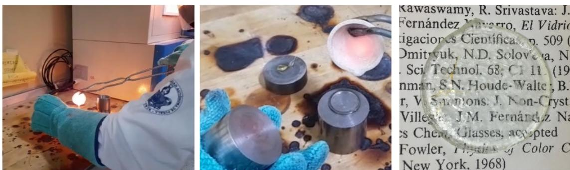
Figura 3.2: (a) Vaciado del vidrio, (b) moldeado y choque térmico, (c) vidrio obtenido.
