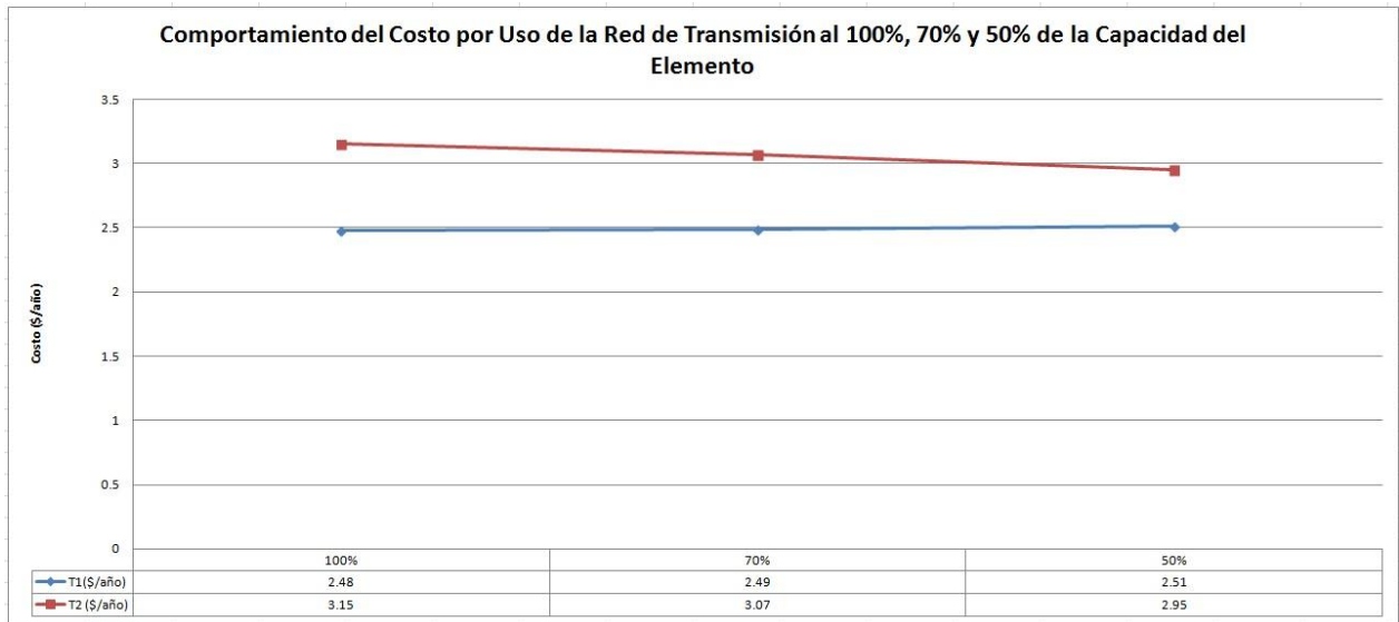
Figura 4.17 Gráfica de Línea que Muestra el Costo de Cada Transacción Considerando un 100%, 70% y 50% de la Capacidad de Cada Elemento.
