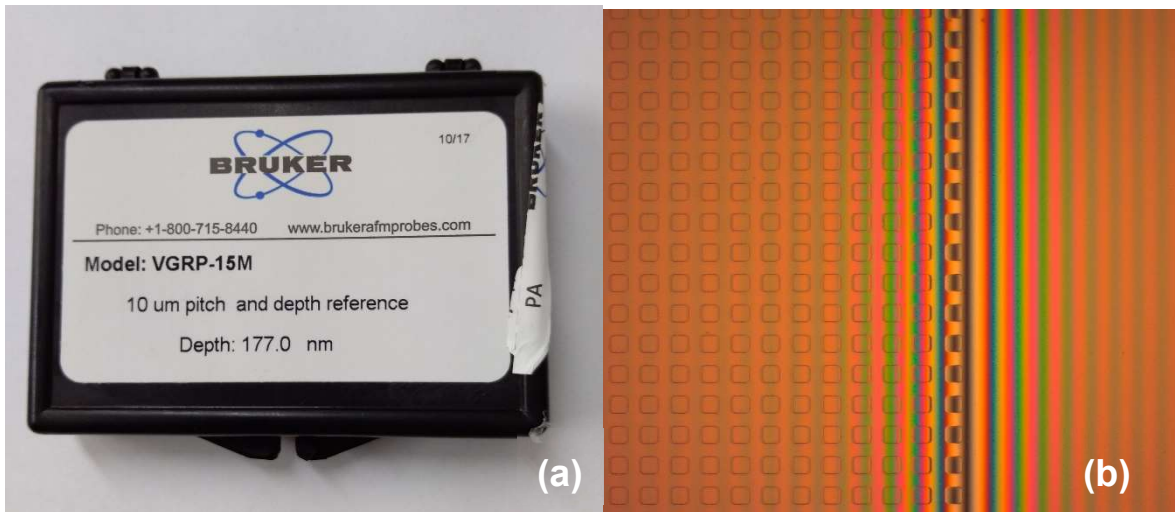
FIGURA 6.4. (a) Especificaciones de la muestra de prueba Bruker VGRP-15M. (b) Matriz de “escalones” de la muestra de prueba.
