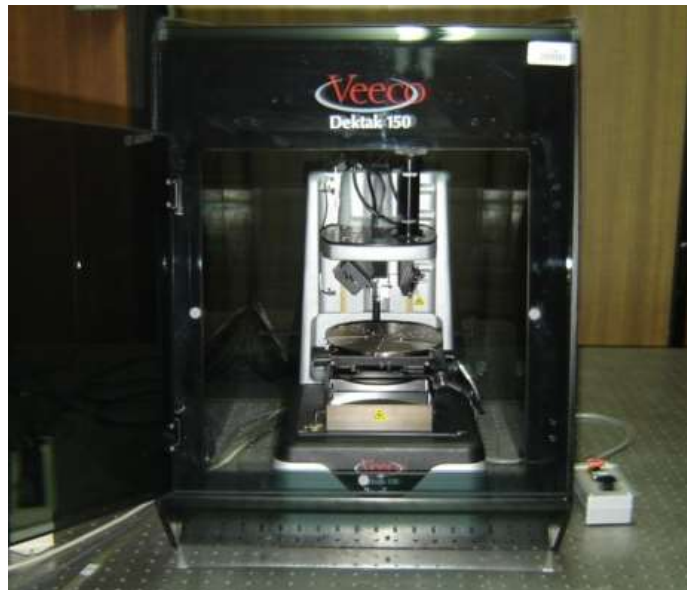
FIGURA A.7. Perfilómetro Veeco Dektak 150 de la marca Bruker localizado en el Laboratorio Central del Instituto de Física de la BUAP.
