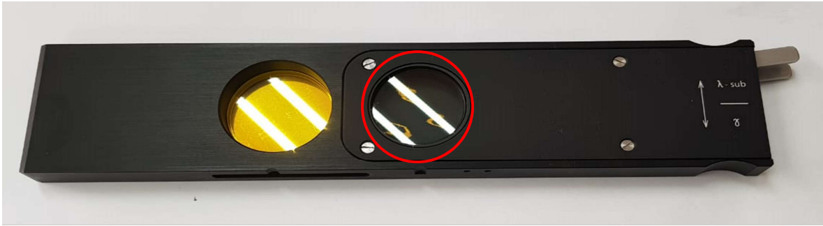
FIGURA 2.9. Remarcado en rojo, filtro de luz que permite pasar una longitud de onda de 544.3 nm fabricado por la compañía Carl Zeiss.
