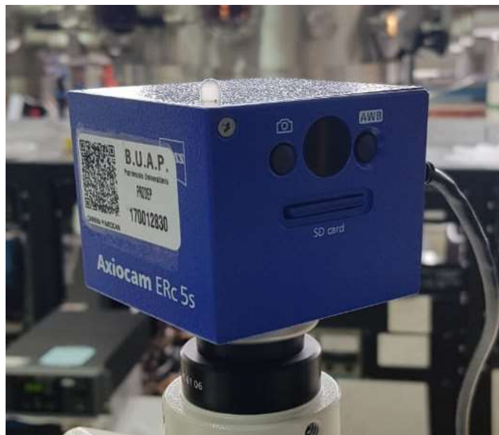
FIGURA 2.10. Cámara AxioCam ERc 5s utilizada para capturar las imágenes provenientes del microscopio AxioPlan 2 imaging.
