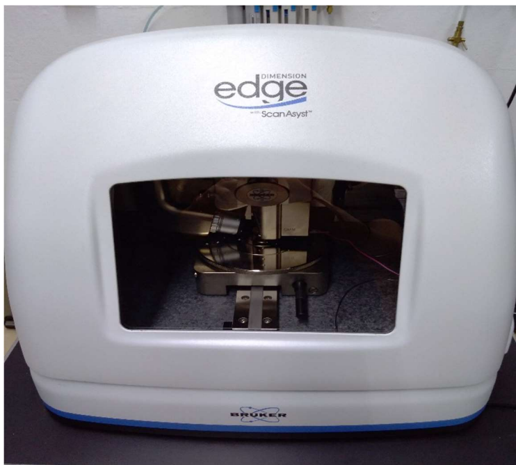
FIGURA A.1. Microscopio de Fuerza Atómica modelo Dimension Edge System de la marca Bruker localizado en el Laboratorio de Microscopía de Fuerza Atómica del Instituto de Física de la BUAP.
