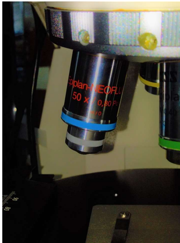
FIGURA 4.2. Objetivo de microscopio de la marca Carl Zeiss usado en el laboratorio para obtener las imágenes del patrón de micro interferencia. En él se observan las propiedades de dicho objetivo.
