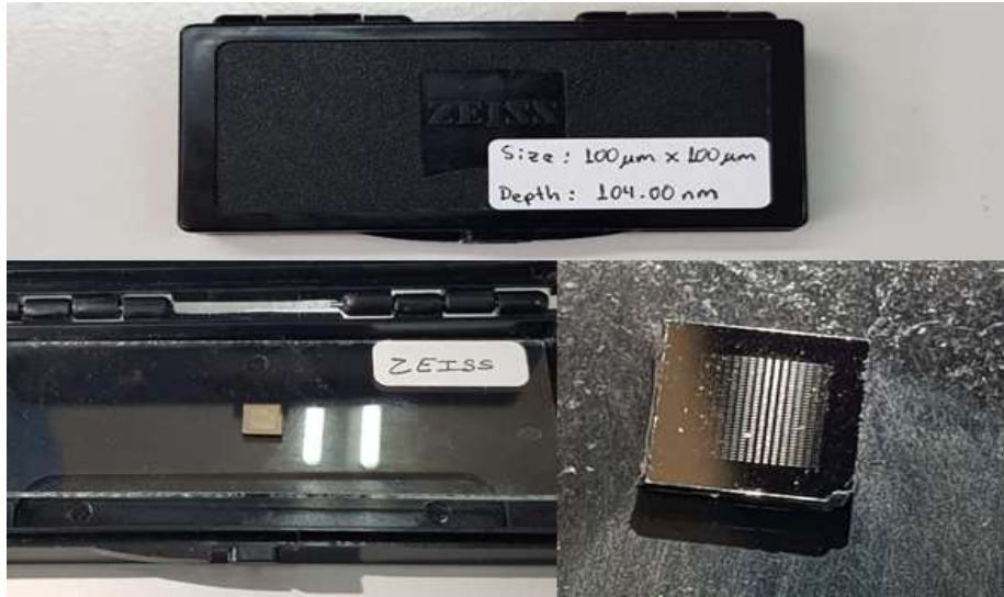
FIGURA 2.13. Muestra de películas delgadas, usada para análisis de grosor, fabricada por Carl Zeiss
