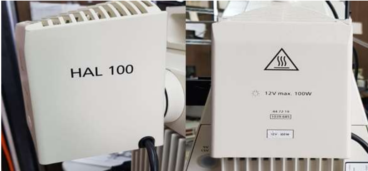
FIGURA 2.6. Lámpara de Halógeno modelo HAL100 como fuente de iluminación del microscopio Axioplan 2 imaging.
