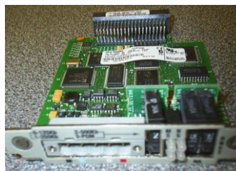
Figura 32: Interfases de comunicación DeviceNet e Ethernet IP
