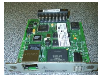
Figura 32: Interfases de comunicación DeviceNet e Ethernet IP
