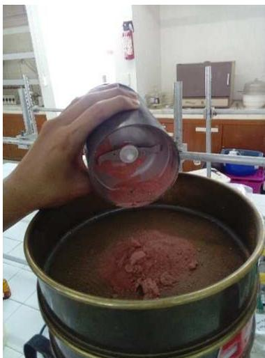
Figura 19. Tamizado de la muestra molida
