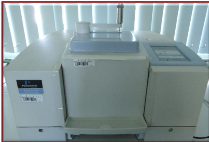
Figura 2.3. Espectrofotómetro infrarrojo con transformada de Fourier y sistema ATR.
