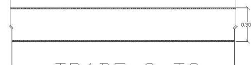
TRABE 2=T2 PERFIL IPR 305 x 165mm 44.645 Kg/m
