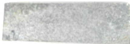
Figura 7: Aspecto del fotoánodo de Al-BiOI/BiOCl-SnO 2 /Sb (R. Ramos, 2017)
