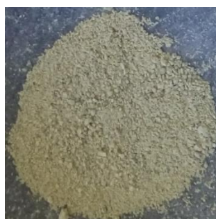
Figura 6: Aspecto del material BiOI/BiOCl-SnO 2 /Sb sintetizado por el método solvotérmico (R. Ramos, 2018)
