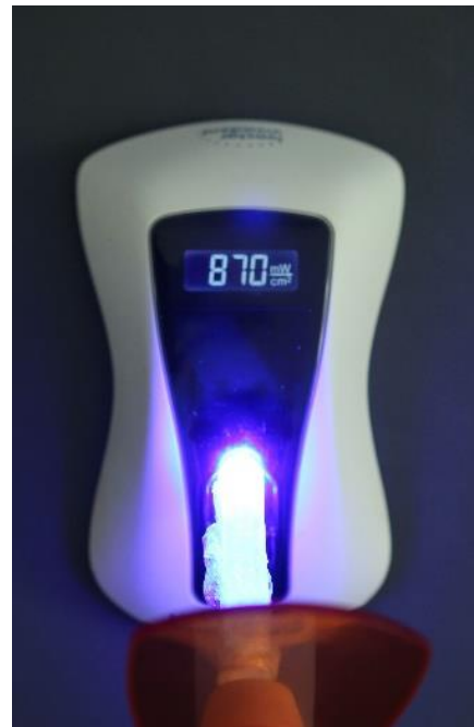
Imagen 2: Evaluación de la UFC LED 3M Elipar ESPE, con un radiómetro Bluephase Meter Ivoclar.
