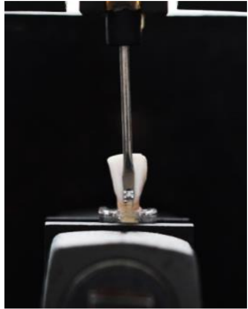
Imagen 4: Prueba de fuerza de Adhesión en INSTRON.
