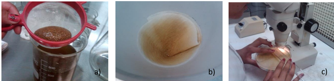
Figura 8. Proceso para la determinación de materia extraña. a) Enjuague de la chíá con agua destilada b) filtración del agua resultante de los enjuagues de la semilla c) Observación al microscopio de las filtraciones. Fotografías: edición propia
