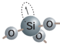
Figura 6 – Representación genérica de un defecto E'- Center. Compuesto de un solo átomo de Silicio enlazado a tres átomos de oxígeno, con una vacancia de oxígeno.
