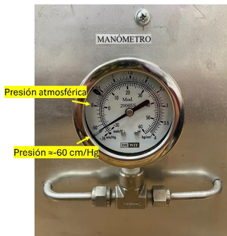
Figura 45 – Manómetro indicando una presión de -60 cm/Hg, confirmando la hermeticidad del sistema
