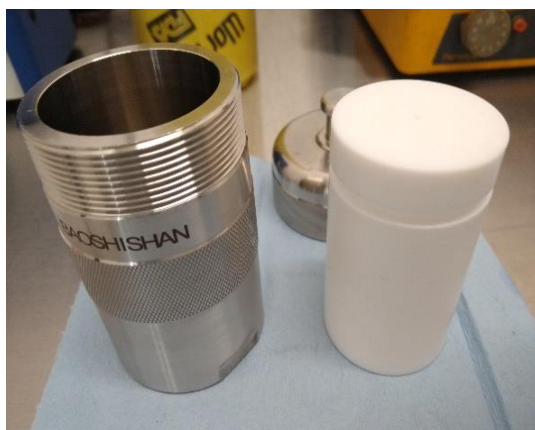
Fig. 2.3-1 Imagen del reactor hidrotermal de PTFE con camisa de acero inoxidable
