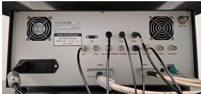
Figura 3.3: Controlador SPM del AFM modelo XE-7 de Park Systems.
