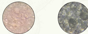
Figura 3. Observación en microscopio óptico de la conformación física de las películas. A. Con mucílago de chia. B. Con mucílago de Nopal.
