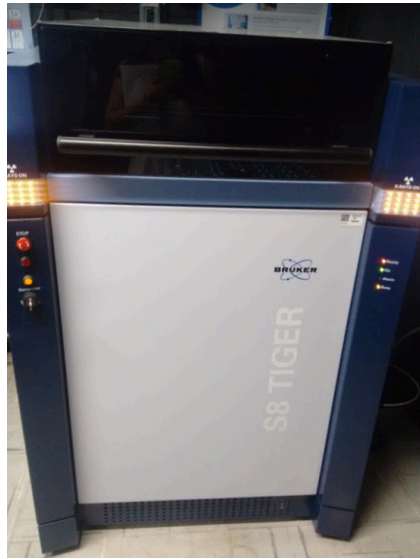
Figura 2-13. Espectrómetro de fluorescencia de rayos-X ubicado en el Centro de Investigación en Dispositivos Semiconductores del ICUAP.
