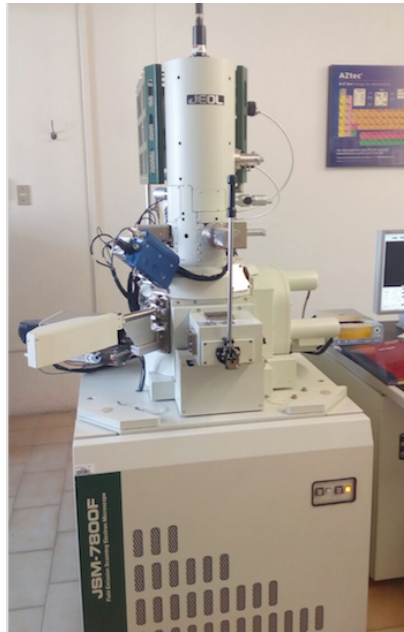
Figura 2-8. Microscopio electrónico de barrido ubicado en el laboratorio de análisis de superficies del Instituto de Física “Luis Rivera Terrazas” de la BUAP.
