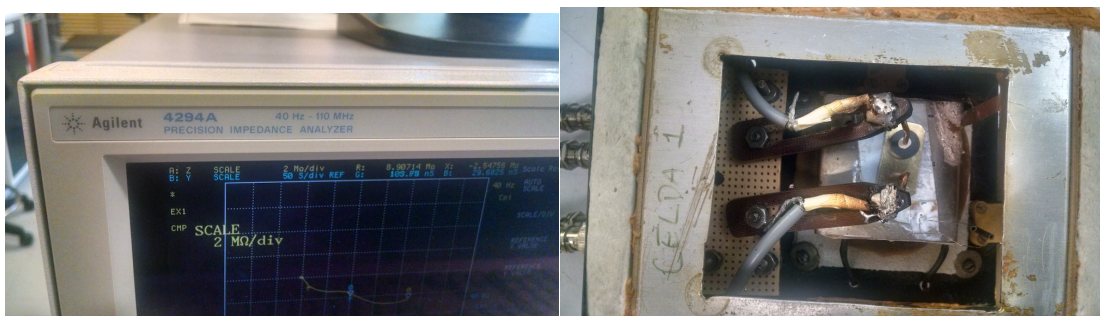
Figura 2-16. Medidor de impedancias. Ubicado en CINVESTAV campus Querétaro.
