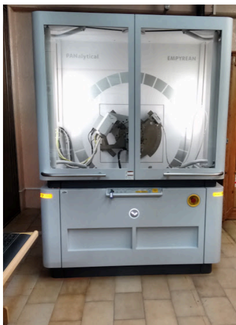
Figura 2-5. Difractómetro marca Panalytical modelo Empyrean, ubicado en el laboratorio de difracción de rayos-X del Instituto de Física “Luis Rivera Terrazas” de la BUAP.
