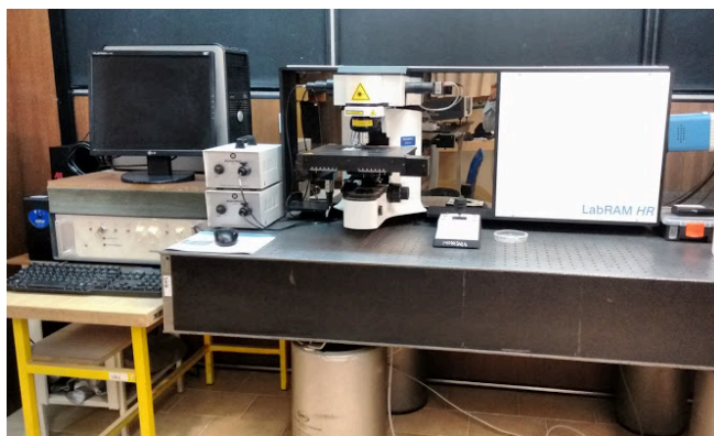
Figura 2-12. Equipo micro Raman ubicado en el laboratorio central del Instituto de Física “Luis Rivera Terrazas” de la BUAP.
