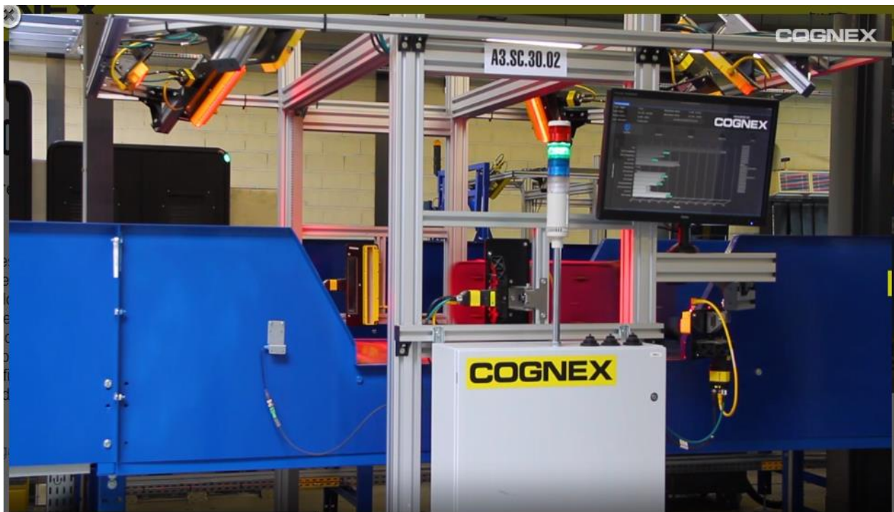
Figura 1.8: Túnel de lectura de Cognex
