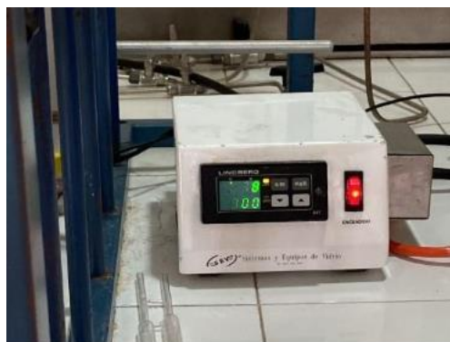
Figura 6. Controlador de temperatura del sistema catalítico.
