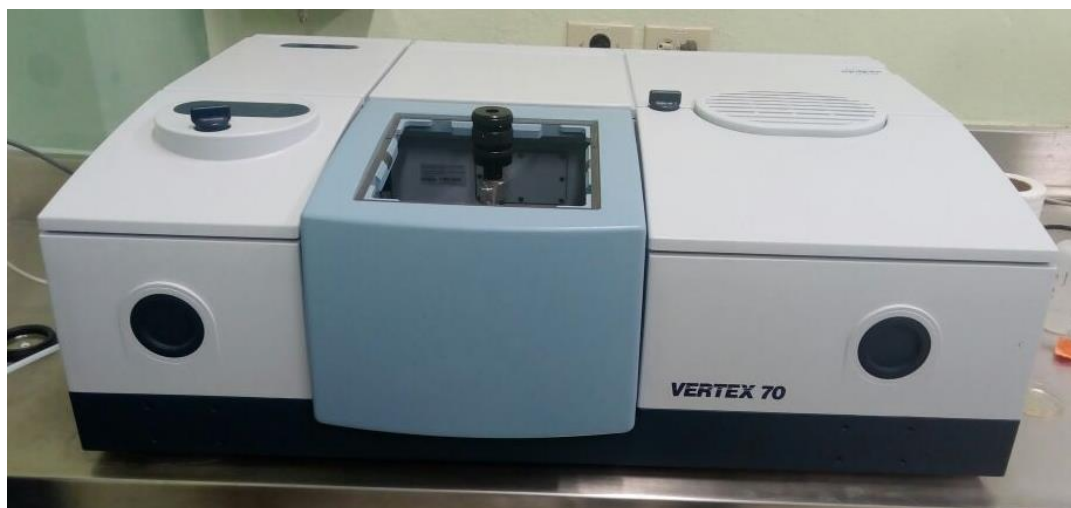
Figura 13. Los grupos funcionales característicos de las muestras de quitosano fueron evaluados en un espectrofotómetro de Infrarrojo marca Vertex 70.
