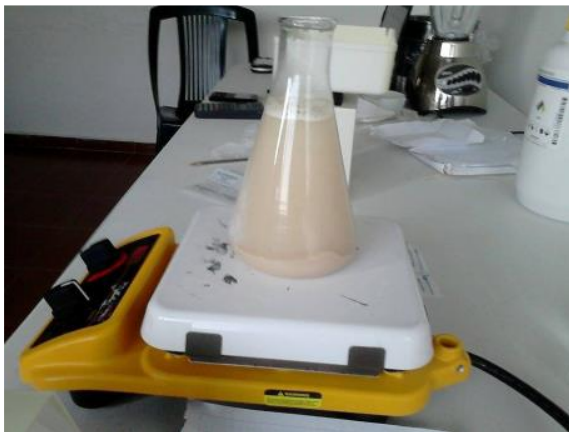
Figura 9. Inmersión en HCl (2N) 1:5, 90 min
