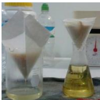
Figura 8. Lavado y filtrado de las muestras después de la inmersión en NaOH (3%) 1:10
