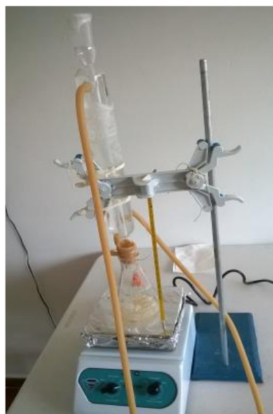
Figura 7. Inmersión en NaOH(3%) 1:10 sol:liq 2h ,80°C
