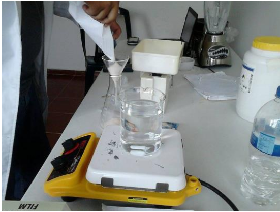
Figura 10. Inmersión en NaOH (50%) 1:10 sol:liq, 1 h , 100°C
