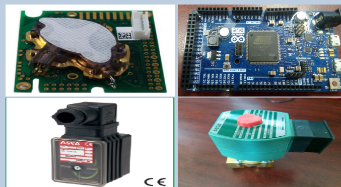
Figura 1: Sensor K30; Tarjeta Arduino Due; Unidad de Control; Electrovalvula.
