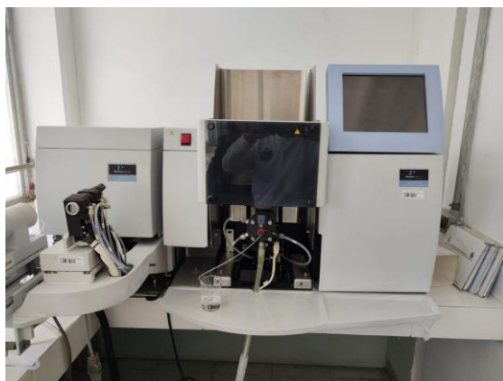
Figura 2.11. Instrumento de espectroscopía de absorción atómica Perkin Elmer modelo AAnalyst 400.
