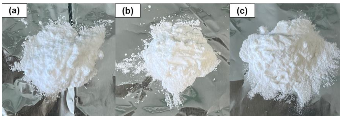
Figura 3.1. Sílice mesoporosa sintetizada con 2% de P123: (a) sin funcionalizar, (b) funcionalizada con grupos tiol, (c) funcionalizada con grupos amina.
