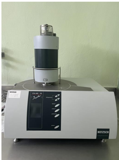
Figura 2.10. Instrumento de análisis térmicos TGA/DSC (NETZSCH STA 449 F3 Jupiter).
