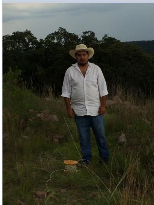
Figura 2.- Cambio de electrodos de potencial previo a la inyección de corriente y toma de la resistividad.
