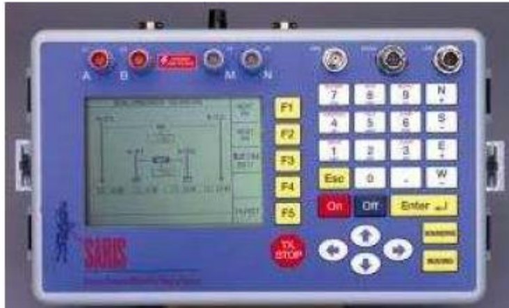
Figura 3.1 Toma frontal del resistivímetro empleado para la adquisición de los datos.
