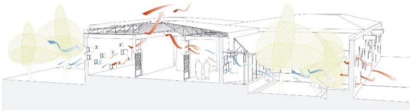
Imagen 1.7.2. Diagrama de ventilación del Centro de salud y promoción social, Laongo. Fuente: ArquitecturaViva.
