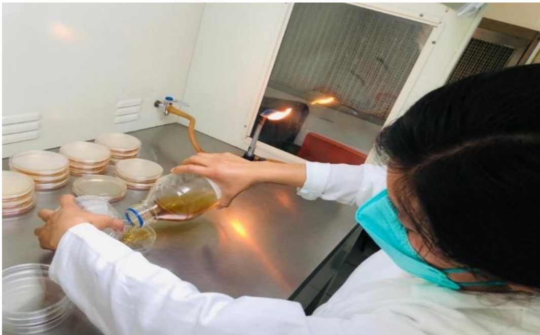
Figura 12. Vaciado de medios de cultivo en cajas Petri en campana de flujo laminar.
