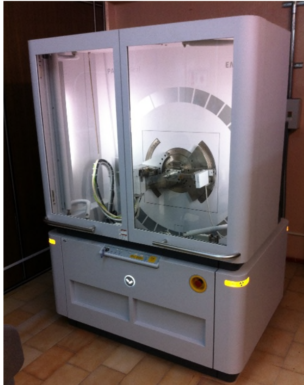
Fig.2.6 Difractómetro de rayos-X para polvos, modelo EMPYREAN de PANalytical.
