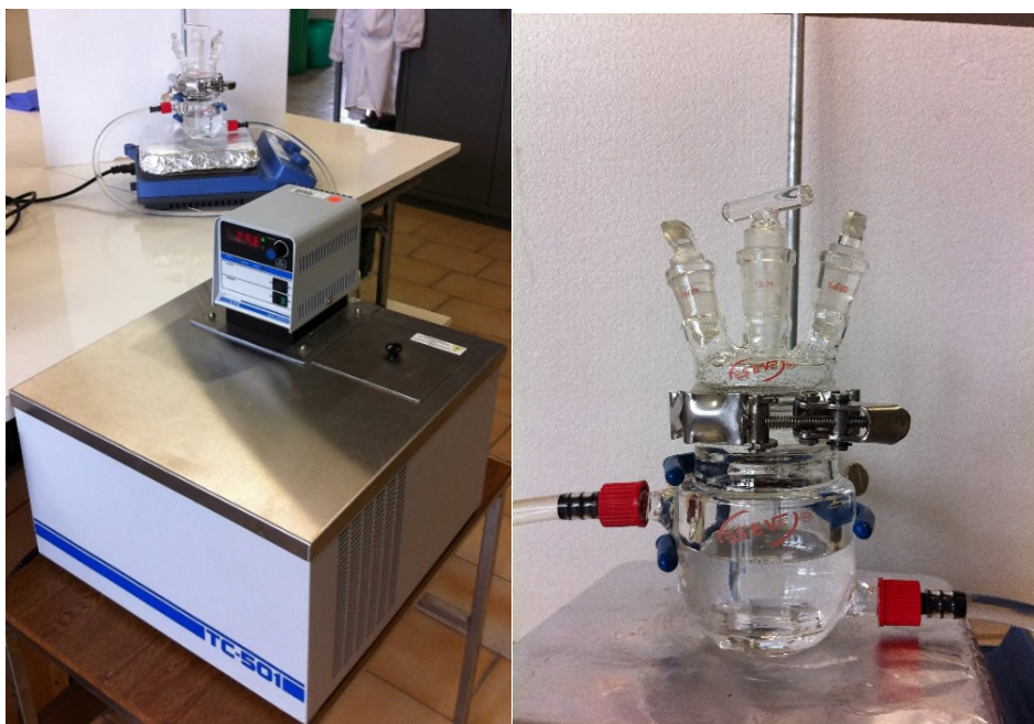
Fig. 2.1 Sistema de crecimiento cristalino utilizado, izquierda, baño recirculador marca Brookfield TC-105D-115 con control de temperatura, derecha, reactor de vidrio en un baño de circuito cerrado continuo, sobre una parrilla de agitación magnética IKA C-MAG HS7.
