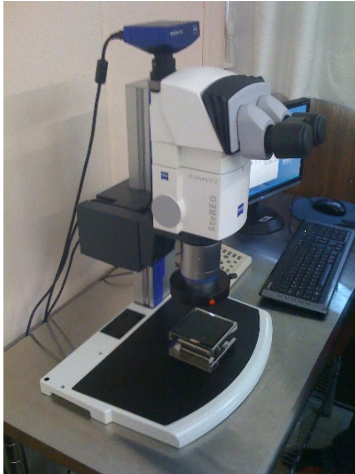
Fig. 2.3 Microscopio Zeiss-Discovery utilizado en la evaluación cualitativa de la calidad cristalina mediante microscopía óptica de luz polarizada.
