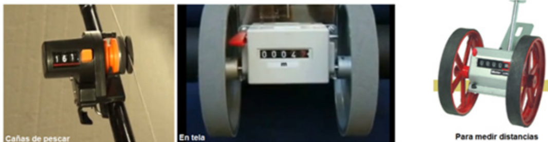
Fig. 53 Aplicaciones dispositivo cuenta metros
