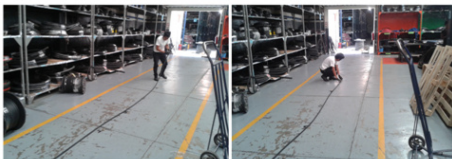
El almacenista debe tirar de la manguera e ir tomando como referencia los metros pintados en el suelo, este proceso se repite tantas veces como sea necesario
