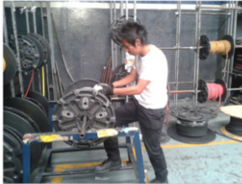
El almacenista debe colocar el carrete sobre el tubo para que este sirva como devanador de la manguera
