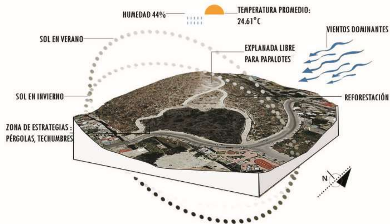
Imagen 2.6.1 Diagrama de estrategias bioclimáticas AUTOR: Elaboración propia.
