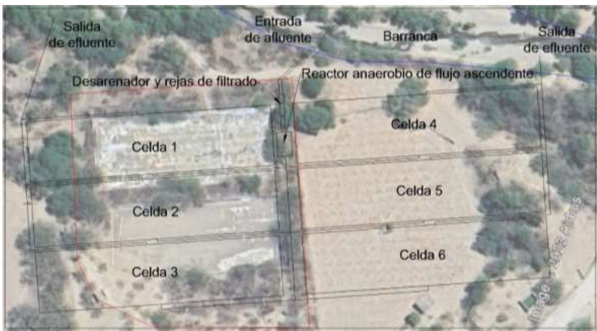
Figura 30 Disposición en el sitio de la planta de tratamiento abandonada de los componentes del humedal artificial. Fuente: Autoría propia.
