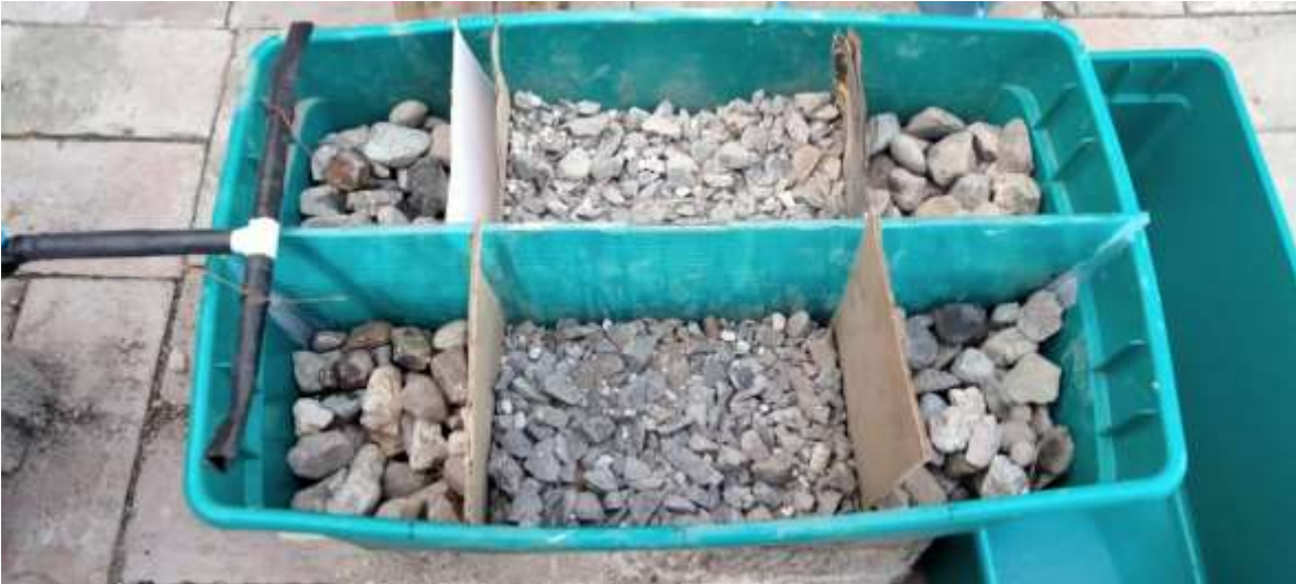
Figura 14 Colocación de sustrato en la caja de plástico, con la división entre área de tratamiento y zonas de entrada y salida. Fuente: Autoría propia.
