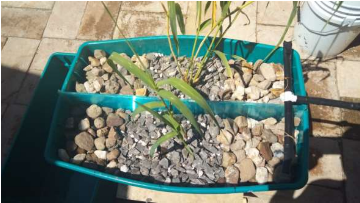
Figura 16 Humedal terminado. Fuente: Autoría propia.
