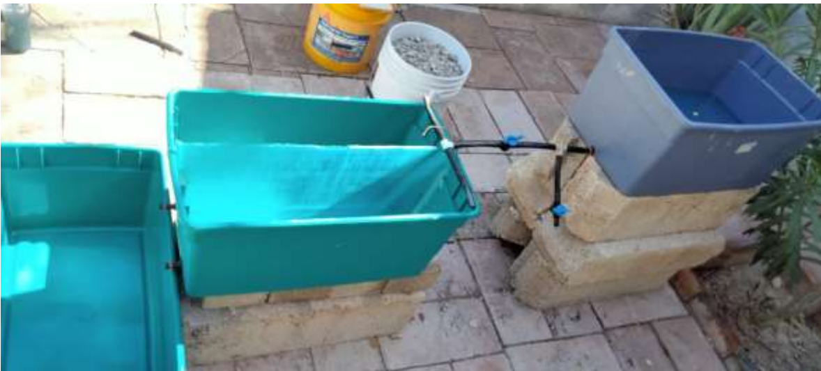
Figura 15 Sistema de goteo para garantizar un caudal constante al humedal. Fuente: Autoría propia.
