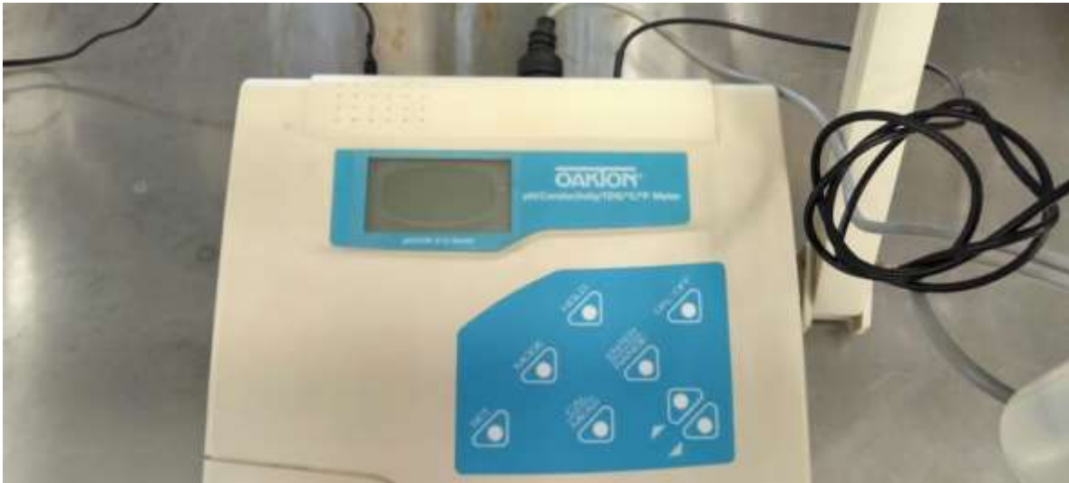
Figura 11 Equipo Oakton pH/CON 510 para medición de pH, conductividad eléctrica y sólidos disueltos totales. Fuente: Autoría propia.
