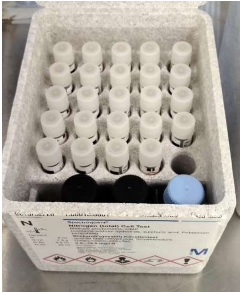
Figura 10 Kit de análisis de nitrógeno total, con los reactivos necesarios para su medición en el fotómetro. Fuente: Autoría propia.
