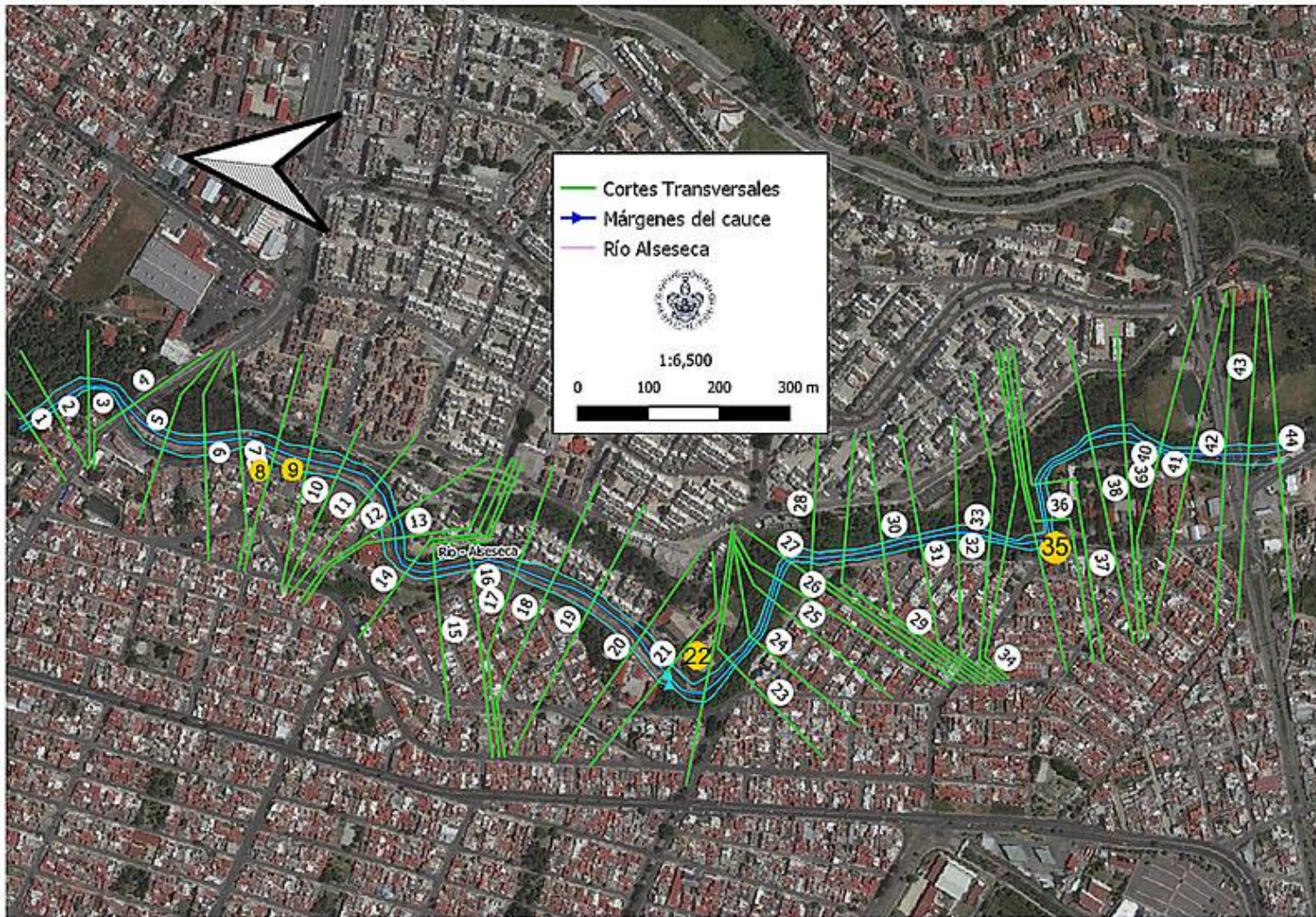
Imagen 15. Cortes transversales del río Alseseca.
