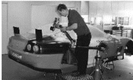
Figura 2. Uso de un brazo faro para digitalizar la carrocería Ferrari 550, Reverse Engineering: An Industrial Perspective, 2008 (pg.149)
