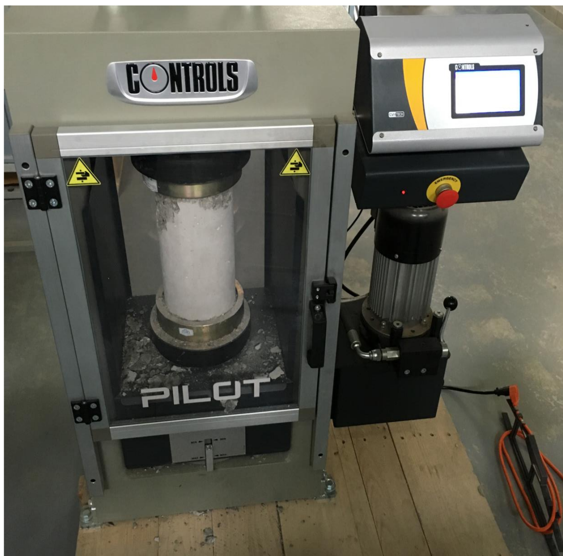
Figura 4.1. Ensayo de resistencia a la compresión para los distintos sistemas
