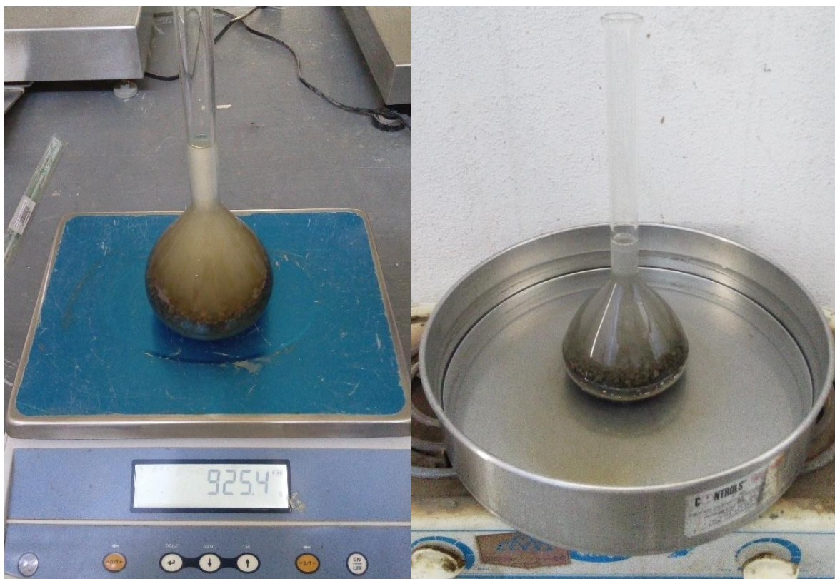
Figura 3.5. Peso específico de arena
