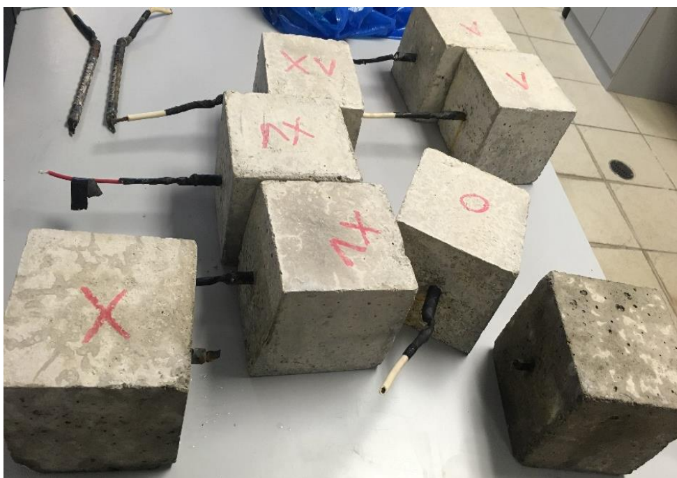
Figura 3.9. Vista del concreto ya habilitado y sin pulido en la cara superior.
