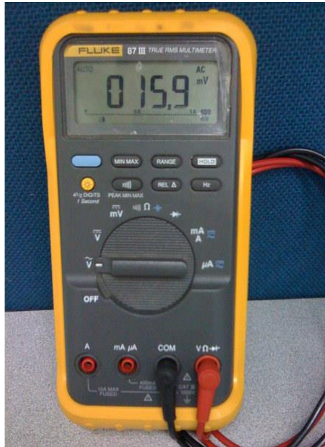
Figura 3.15 Instrumento y accesorio empleado para monitoreo de potenciales de corrosión
