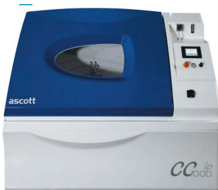
Figura 2.7. Cámara para ensayos de niebla salina y corrosión cíclica.
