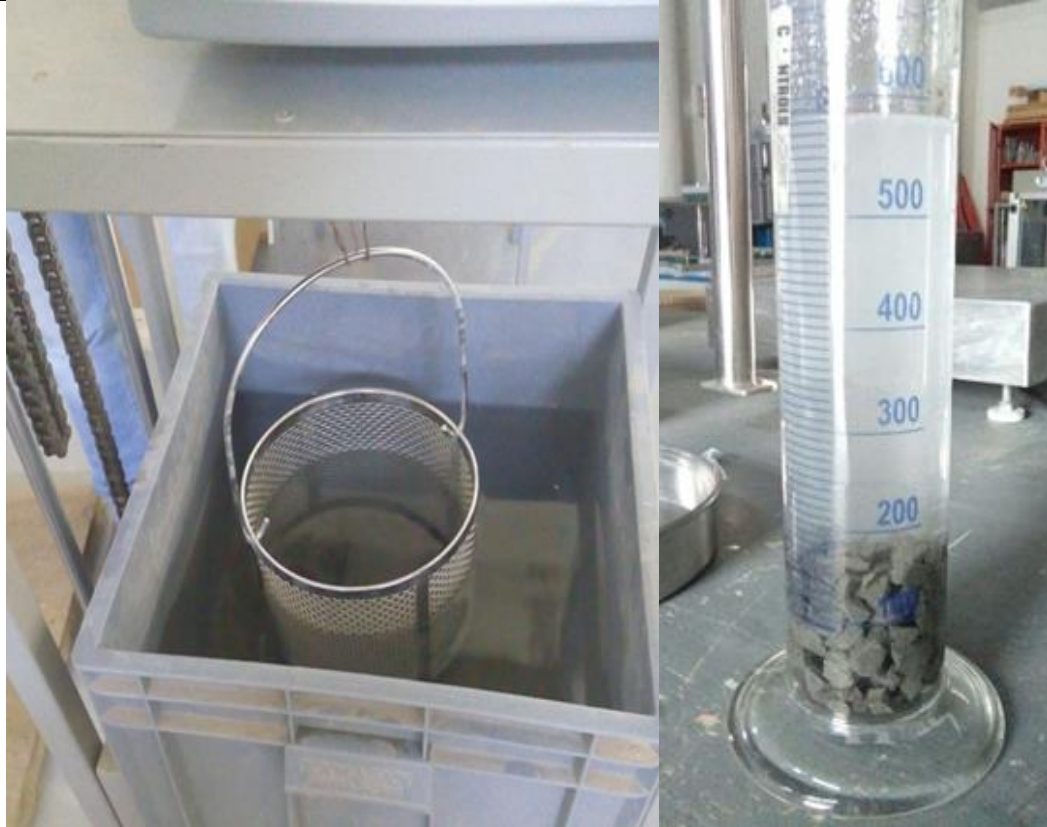
Figura 3.4. Peso específico de grava
