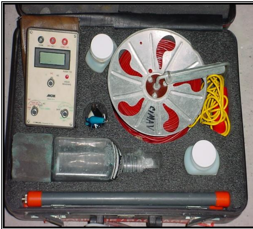
Figura 2.12 Instrumentos y accesorios empleados para el monitoreo de potenciales de corrosión.
