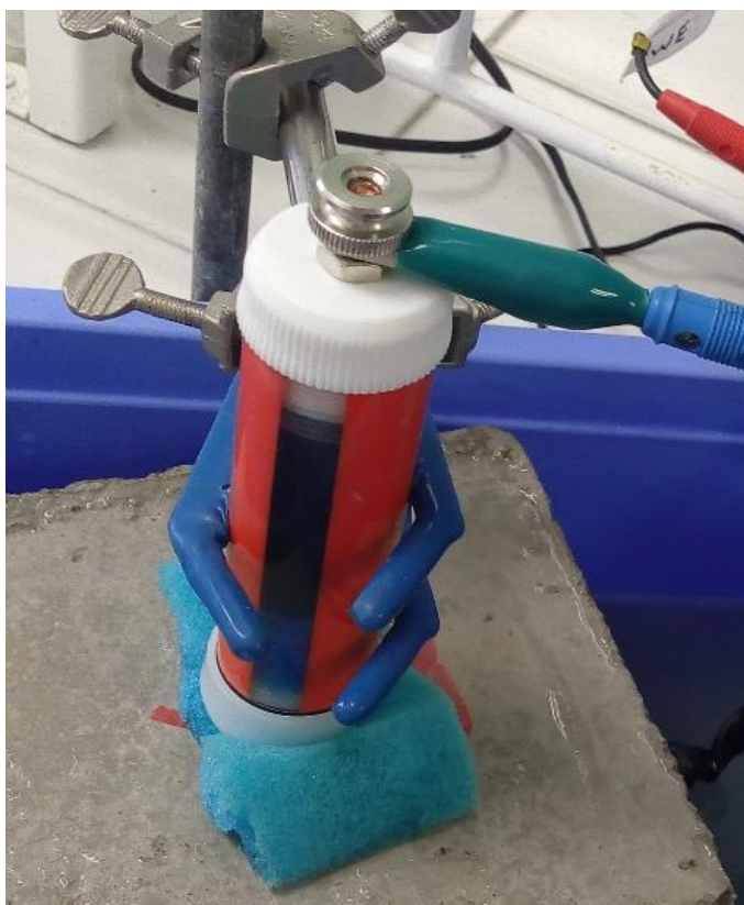
Figura 3.14. Electrodo de cobre-sulfato de cobre
