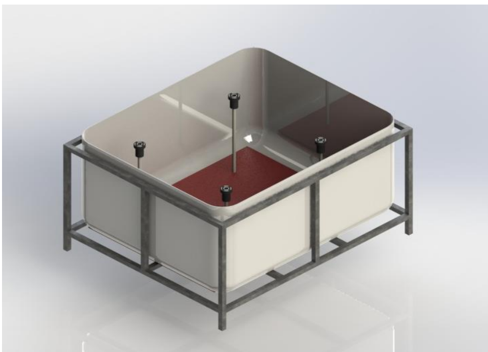
Figura 3.11. Cámara de aspersión salina.
