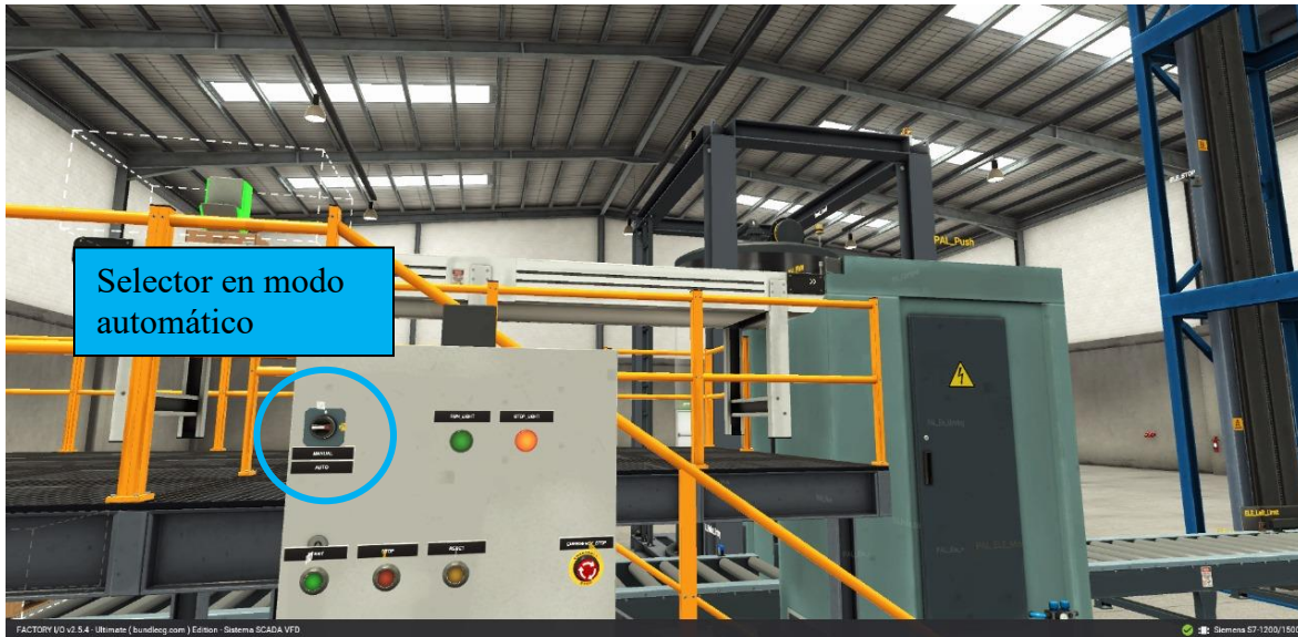
Figura 4.15. Proceso industrial en modo automático para control a distancia.
