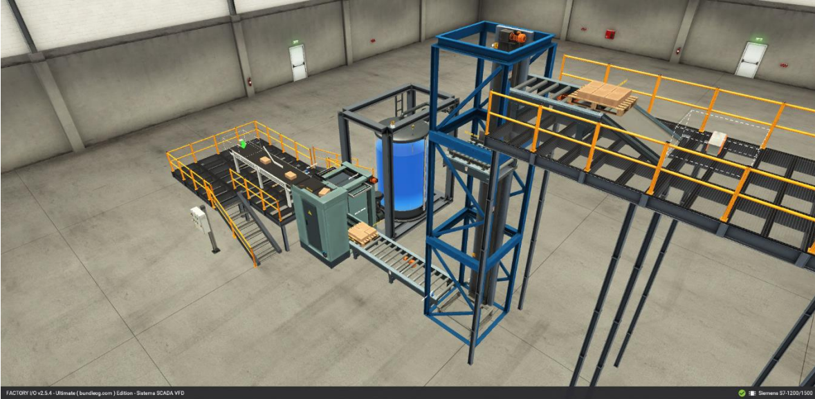
Figura 4.6. Subproceso del elevador y entrega de palet en funcionamiento.
