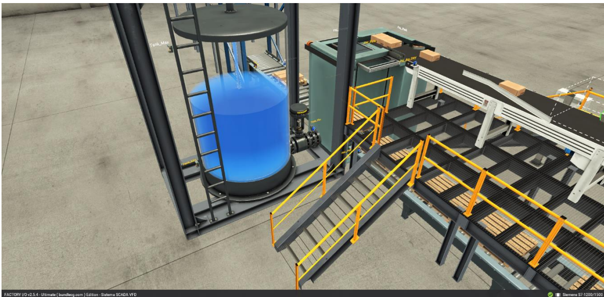
Figura 4.5. Subproceso del tanque de suministro de agua en funcionamiento.
