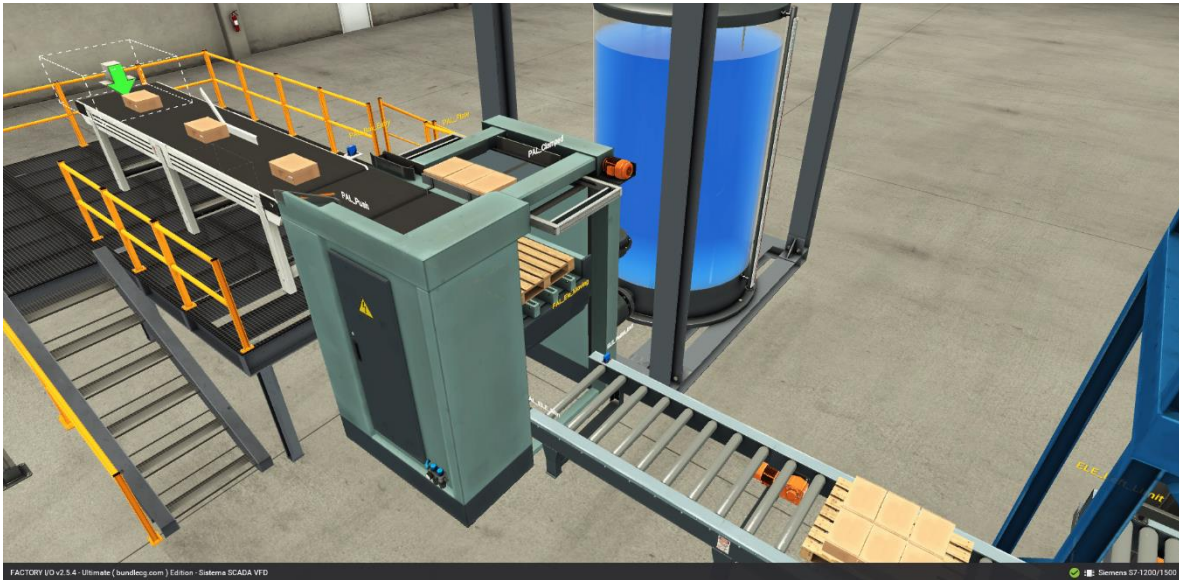
Figura 4.4. Subproceso de paletizado en funcionamiento.
