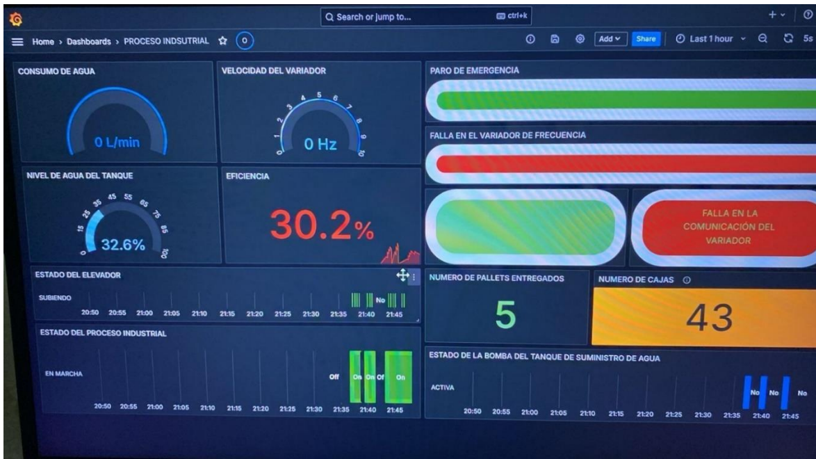
Figura 4.14. Alerta de falla de comunicación del variador en Grafana.
