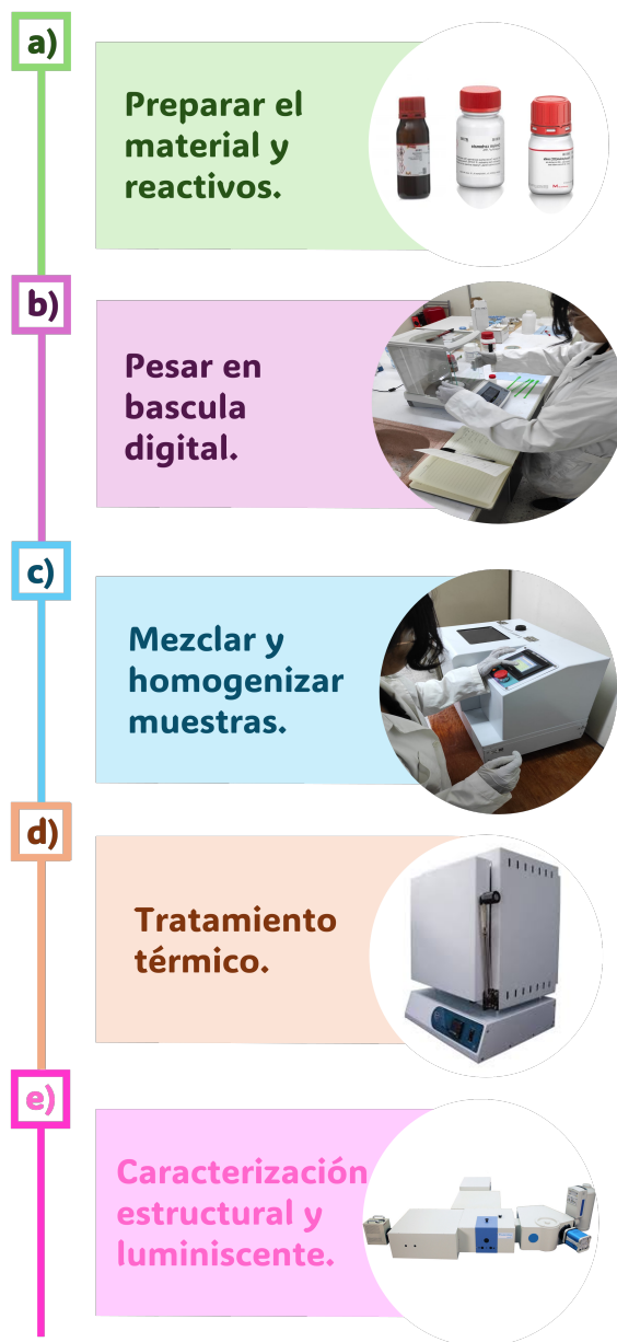
Figura 2.1: (a) Preparación de los reactivos y material a utilizar; (b) pesaje correspondiente a cada muestra en balanza digital; (c) colocación del material en molinda mecánica para mezclar, homogenizar y moler; (d) tratamiento térmico en mufla; (e) caracterización estructural y luminiscente.
